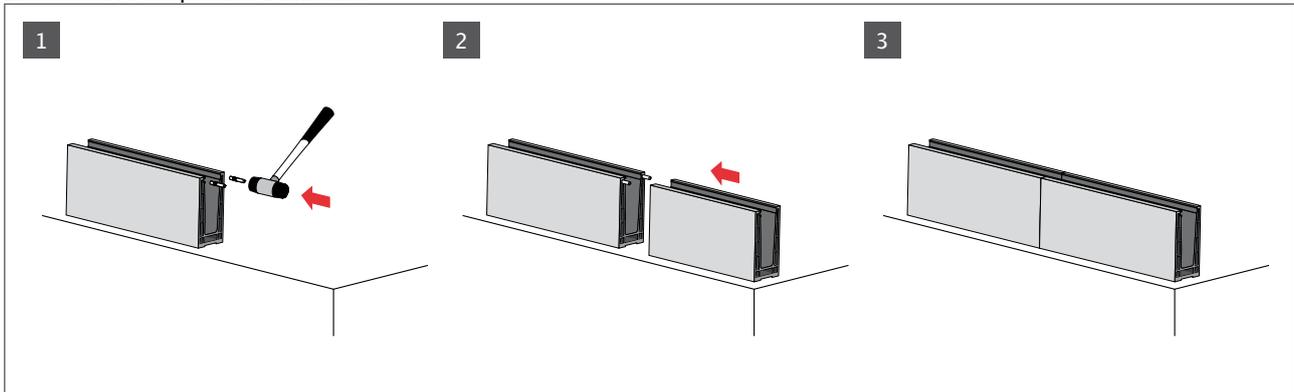
Joints en caoutchouc entre les volumes de verre (distance min : 1mm / distance conseillé : 10mm)
