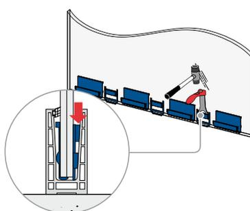
**!** Le dispositif de sécurité de la cale supérieure doit être placé en contact avec la base inférieure du profil.
