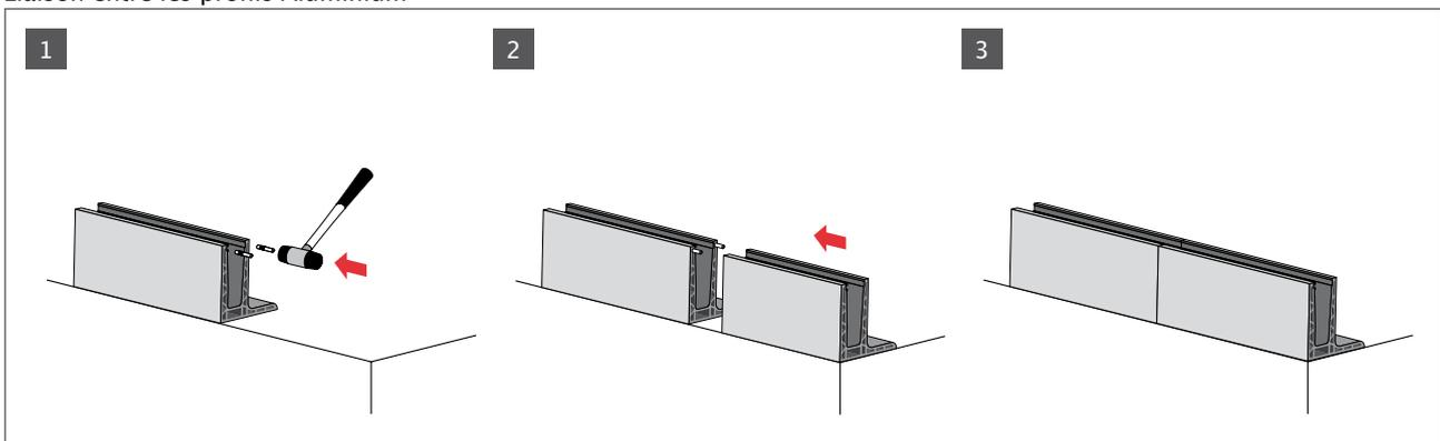
Joints en caoutchouc entre les volumes de verre (distance min : 1mm / distance conseillée : 10mm)
